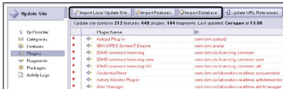
Рис. 2-5. Импорт в базу обновлений. В созданную на сервере базу Update Site было импортировано содержимое директории Updatesite (архивный файл updatesite.zip из дистрибутива Lotus Notes 8 Standard).
